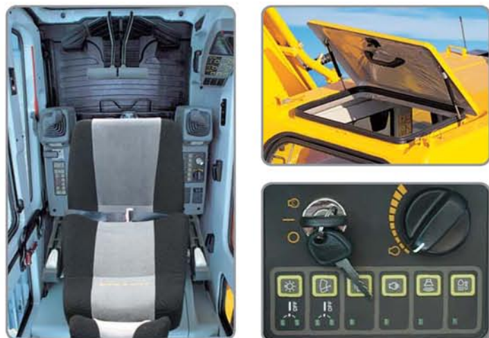
1 Espaço de Operação Amplo, Confortável 2 Teto Solar com Tampa de Aço 3 Comando Giratório da Velocidade do Motor e Chave de Ignição
